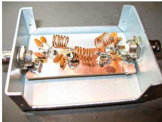
Figura 3: Il filtro assemblato in un piccolo contenitore d'alluminio con i connettori BNC che ne permettono il collegamento.
